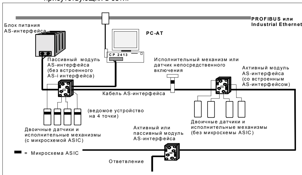
Рисунок 2-8 Пример конфигурации системы с PC-AT и CP 2413
